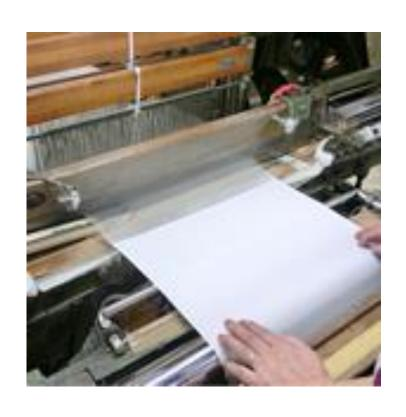
手機は織り手による打ち込み強さのばらつきや、打ち込みタイミングのずれが生じやすく、品質の安定を保つ上で常に悩みの種でした。このため牛首紬では、引き杼を使用した手機に近い構造でなおかつ打ち込みが安定する「玉糸機」を考案し導入。職人がそれぞれ一台を受け持ち、丁寧に織り上げます。それでも緯糸は繊度むらが多く、これらの糸を取り除く熟練の目と手技が牛首紬の品質を決定します。
